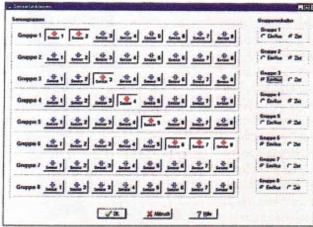
Bild 8. Der Bildschirm zur Programmierung der Sensorfunktionen: in senkrechten Spalten angeordnet die einzelnen Kanäle, in Zeilen die jeweilige Gruppe.
